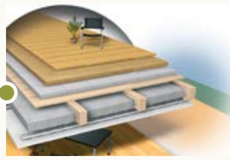
flexCL® tussen het latwerk van tussenplafonds. Met name in ruimten met hoge eisen aan de geluidsisolatie is dit een oplossing voor de isolatie.
